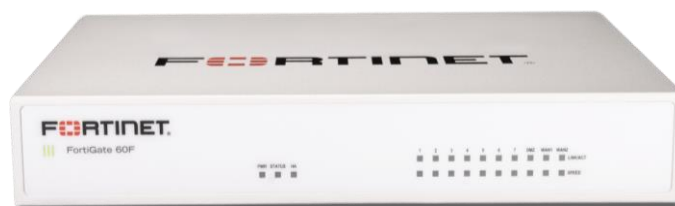
ภาพที่ 4 อุปกรณ์ Firewall ยี่ห้อ FORTINET ที่ใช้งานอินเทอร์เน็ตวงจร TRUE ภายใน
