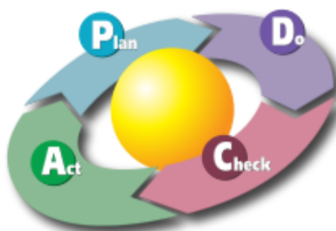
ภาพที่ ๒ วงจร PDCA หรือวงจรเดมิง (Deming Cycle)
